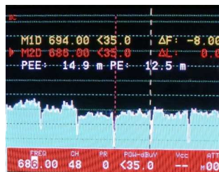
Funzione CLC: calcolo della distanza del disadattamento d'impedenza
